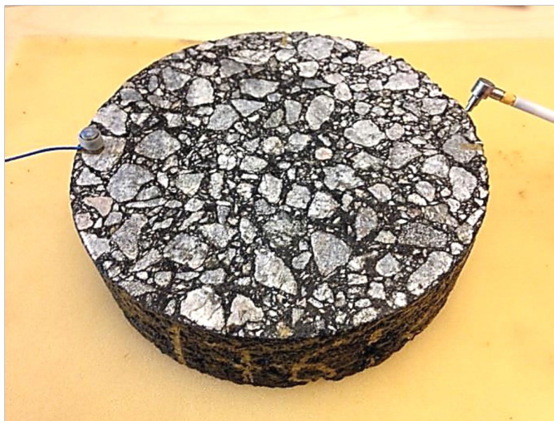
Figur 1. Hammare och accelerometer för att utföra provning genom modalanalys på en asfaltprovkropp (Gudmarsson 2014)
